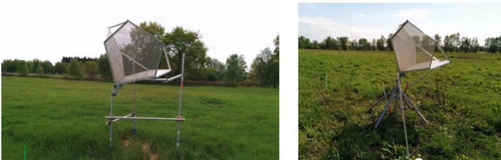
**Abbildung 11:** „Schwimmender“ Radarreflektor zur Erfassung der Geländehöhenänderung an einem Moorgrünlandstandort (links), im Mineralbodenuntergrund fixierter Radarreflektor zur Korrektur atmosphärischer Einflüsse (rechts). © Arndt Piayda
